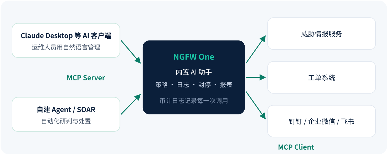
图 1 双向 MCP：外部 AI 通过 MCP Server 管理防火墙；内置 AI 助手通过 MCP Client 调用外部工具
